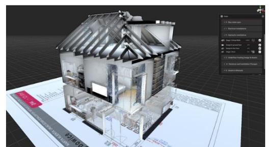
■2D 図面や BIM モデル、点群データまでも重ね合わせ計画内容と施工状況の差異を確認できるイメージ
