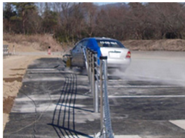
■車両衝突時のワイヤロープ式防護柵（寒地土木研究所 HP 引用）
