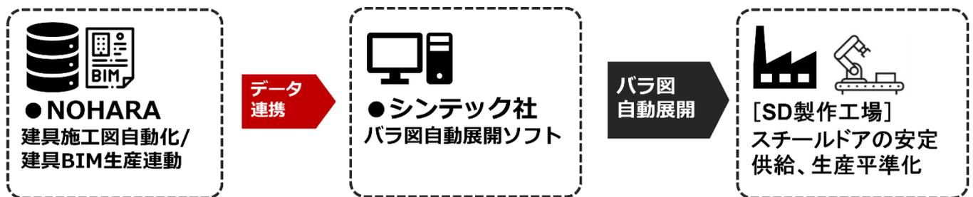
■スチールドアに関する3D-BIMデータの製造バラ図自動化事業のイメージ
