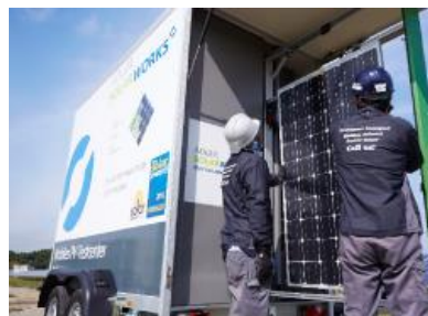
図 2-17 PV テストカーによるパネル評価（アドラーソーラーワークス取組例）
