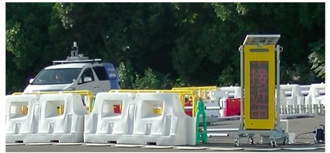
■「路車間協調表示装置」が、自動運転車両の意思を周囲に伝えている様子 (群馬大学次世代モビリティ社会実装研究センターにて)
